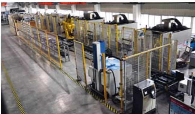
La première installation de production flexible de gros moules réalisée par Robotec travaille en Chine depuis 3 ans. Le robot Fanuc se déplace sur un rail de 30 mètres de long.
