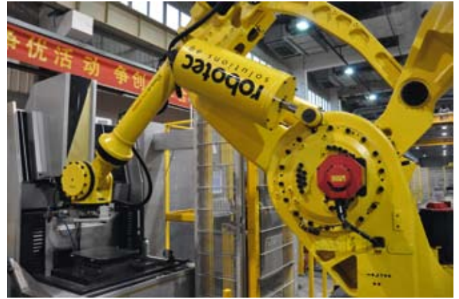
Capable de manipuler des charges jusqu'à 700 kgs, le robot Fanuc charge les palettes System 3R sur les centres d'usinage avec une grande précision.
