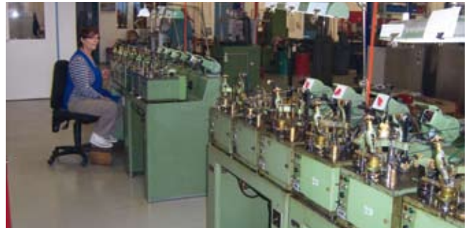
Ligne de fabrication constituée de machines Schläfli pour l'usinage de formes bombées, de formes creuses et de chanfreins.
