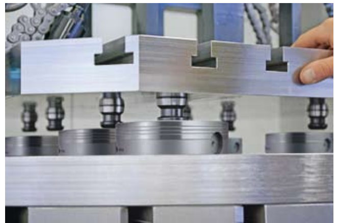
Effizienz du temps : Le système de palette à changement rapide Vero-S minimise les temps de mise en train tout en assurant la précision.
