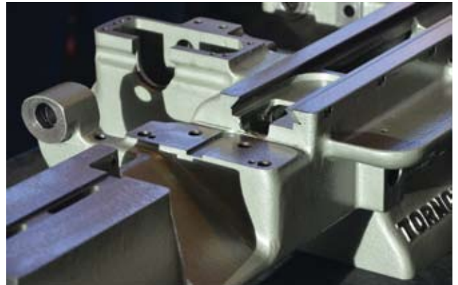
Bâti Tornos M4 prêt à être assemblé.
