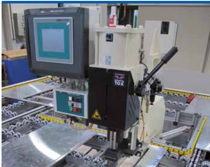
Station de clinchage intégrée à l'installation de production. Clinchstation in der Produktionsanlage. Production facility with integrated clinching unit.
