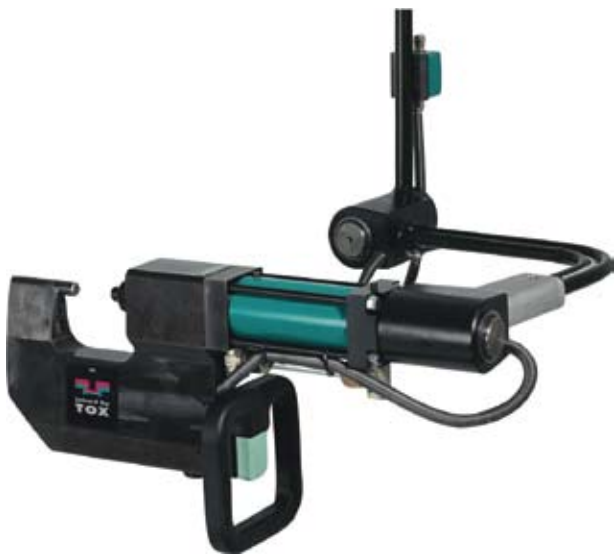
Paire de pincés TOX® sur une suspension avec l'approvisionnement hydraulique intégré dans son système de transmission rotatif.
