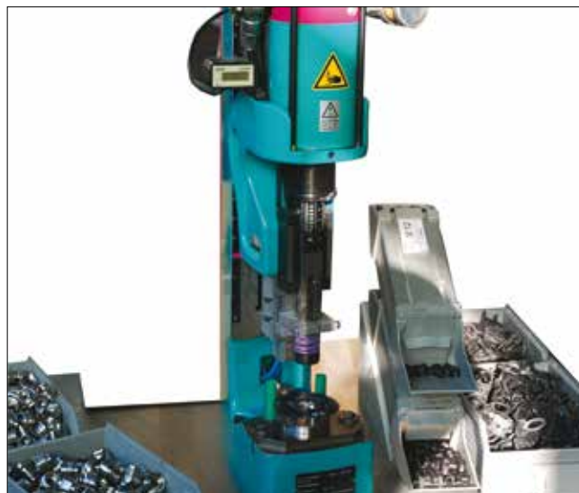
Presse pneumatique Tox-FinePress PFL, avec laquelle les plateaux porteurs sont sécurisés sur les soupapes d'auto-cuiseurs avec le support de la membrane.
