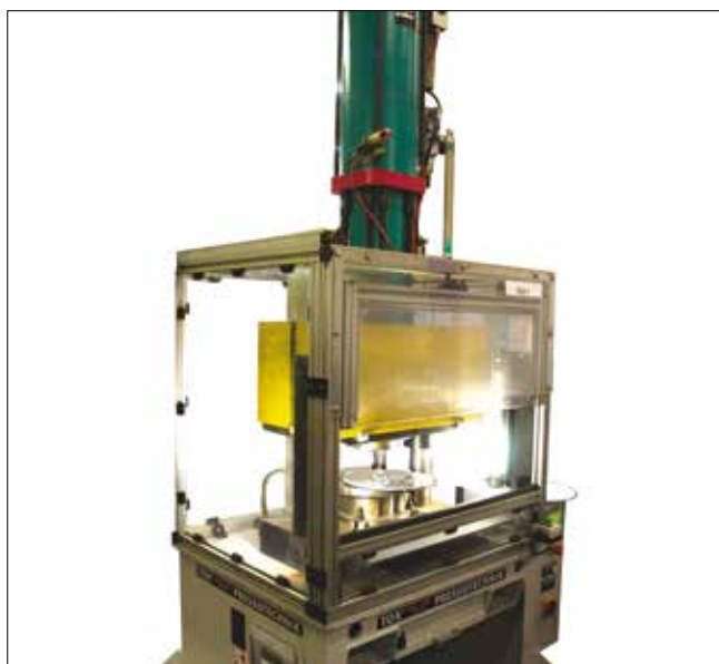
Presse Tox de la gamme MBG qui permet d'assembler des ébauches en inox avec des ébauches en aluminium.
