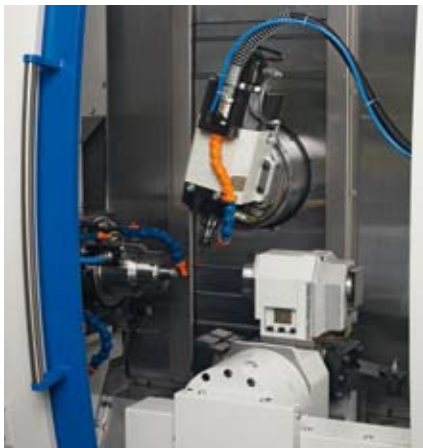
Centre d'usinage 508MT avec tourelle de reprise à 3 positions utiles (contrebroche, étiau, contrepointe).
