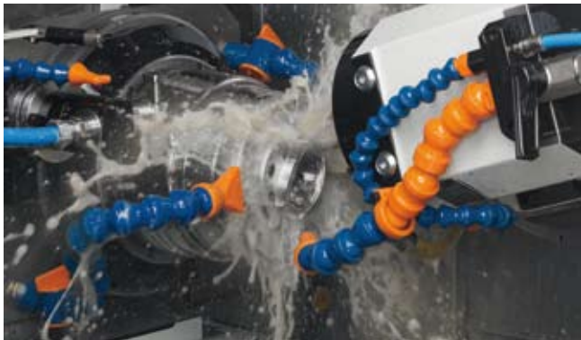
Fraisage-tournage sur centre d'usinage 508MT à partir de barre ou de lopins (barres Ø maxi 42 mm en standard, Ø 65 mm en option).
