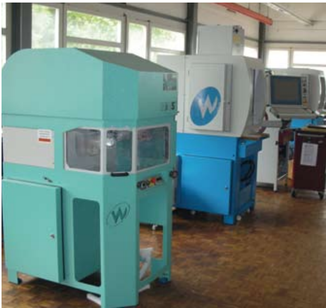
Au premier plan, la fameuse MIC5 qui permet la réalisation de travaux dentaires aux meilleurs coûts. Juste derrière, un centre d'usinage vertical 614 à 5 axes simultanés.
