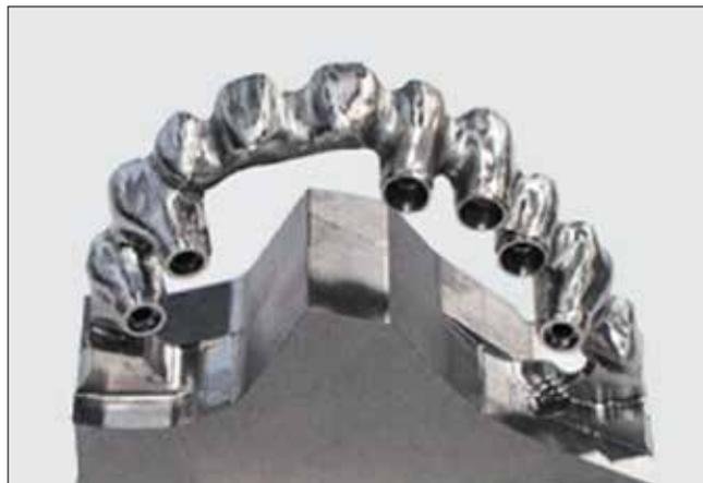
Couronne dentaire usinée avec le centre d'usinage HSM 400U de GF Machining Solutions. (Source : GF Machining Solutions)
