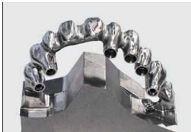
Couronne dentaire usinée avec le centre d'usinage HSM 400U de GF Machining Solutions. (Source : GF Machining Solutions)
