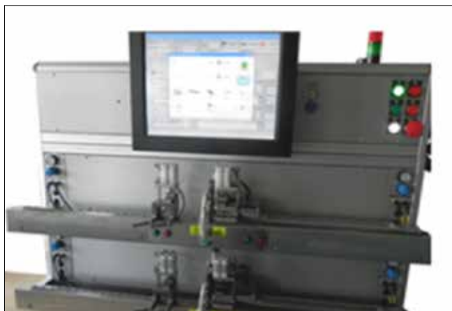
Flexible et productive, la machine Easy Tip a été conçue par Statice pour la soudure haute précision des tubes pour cathéters. (Source : Statice)
