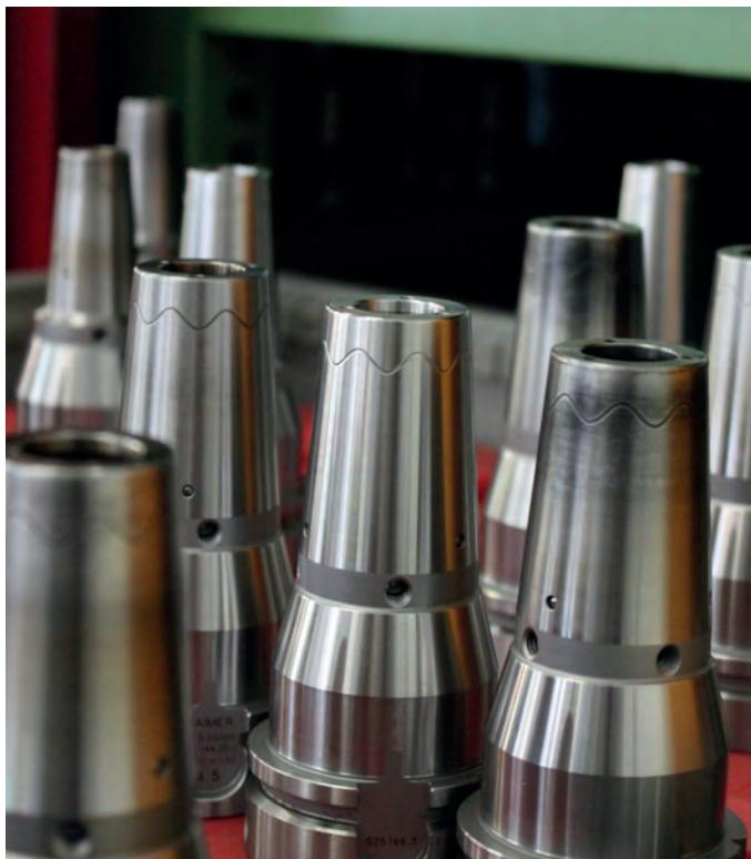
Porte-outils de frettage Power Shrink Chuck de différents diamètres.
