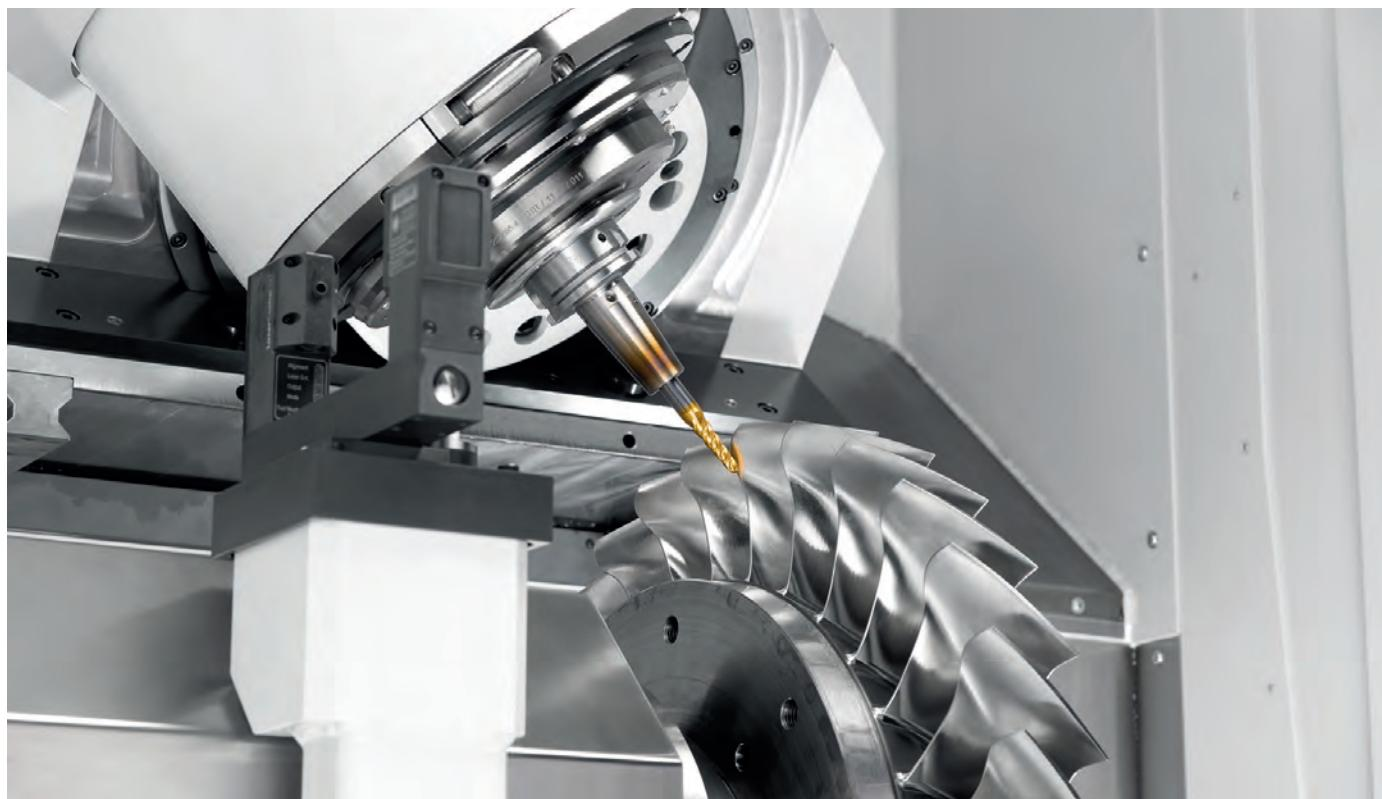
Usinage de composants de turbine.
