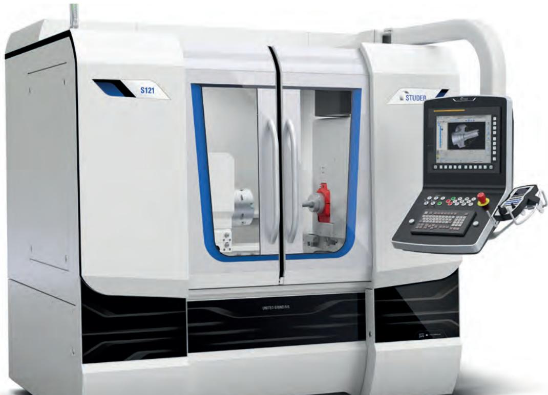
La nouvelle rectifieuse cylindrique interne S 121 de Fritz Studer SA usine en petites séries des pièces de taille moyenne.
