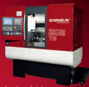
Machine de haute précision et production alliant tournage et rectifiage
