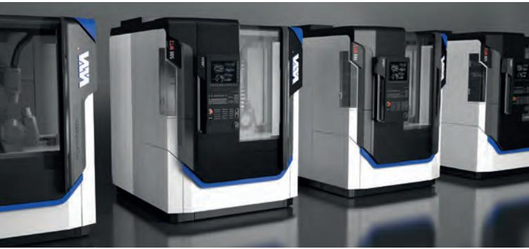
Um noch bessere Ergebnisse zu erzielen, hat Willemin-Macodel einen ausgeklügelten Algorithmus entwickelt, der die durch die thermische Ausdehnung verursachten parasitären Bewegungen im Kraftfluss sowie die kinetostatischen Effekte der Motorspindeln ausgleicht. Die Maschine erweist sich als extrem stabil und benötigt keinen Vorwärmzyklus, um eine sehr hohe Präzision über beliebig viele Bearbeitungszyklen zu gewährleisten.
