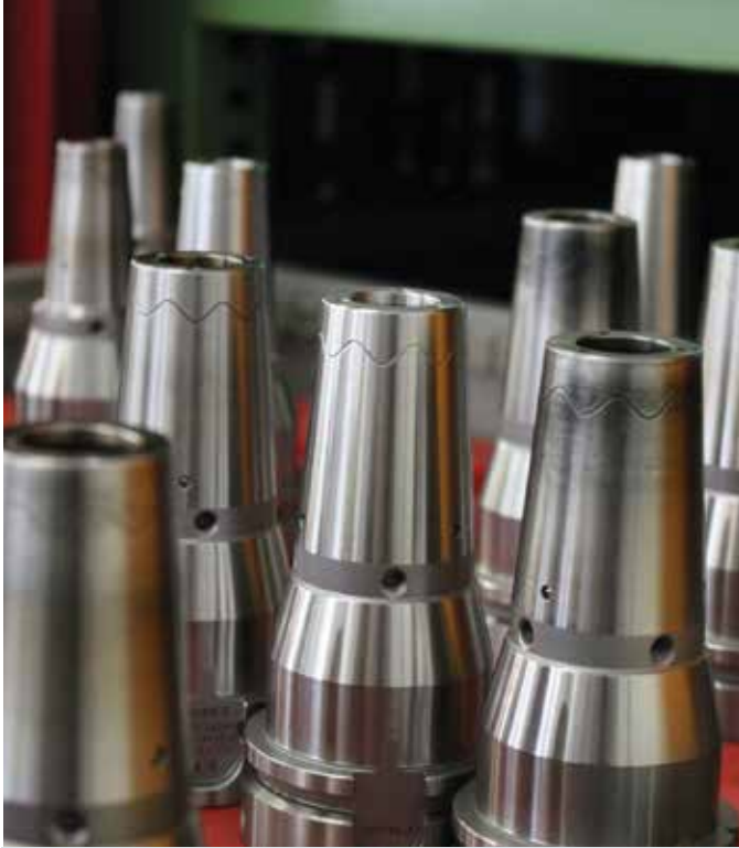
Porte-outils de frettage Power Shrink Chuck de différents diamètres. Power Shrink-Schrumpffütter div. Durchmesser. Power Shrink Chuck tool holder of various diameters.
