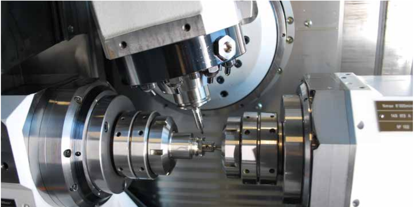
Usinage en simultané avec broche diviseur en axe A et contre-broche sur tourelle de reprise. Simultane Bearbeitung mit Teilspindel auf der A-Achse und Gegenspindel auf der Abgreifeinheit. Simultaneous machining with dividing spindle on the A-axis and counter-spindle on the backworking turret.
