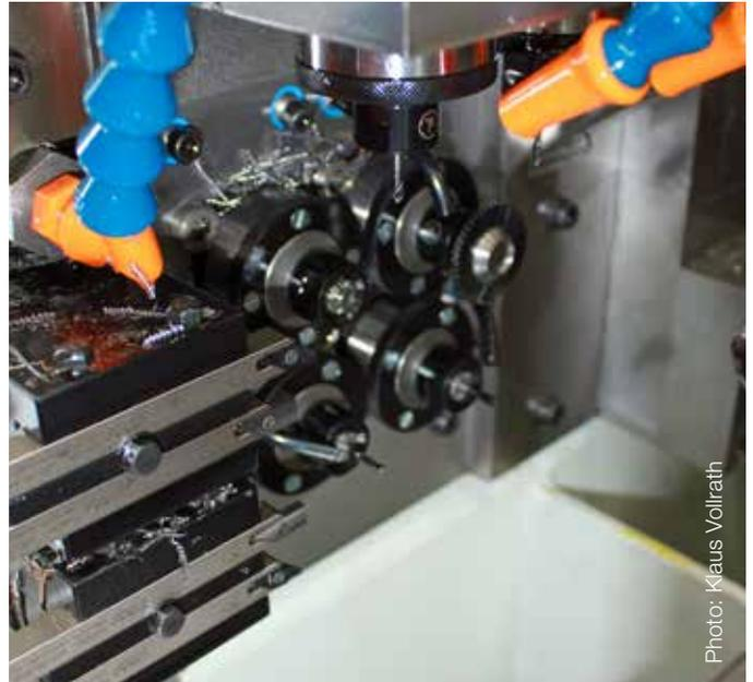
L'unité DUAL reprend les pièces au moment où elles sont tronçonnées et les transfère dans la deuxième station pour achever leur usinage à l'aide de quatre broches axiales et de deux broches orientées verticalement.
