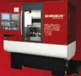
Machine de haute précision et production alliant tournage et rectifilage
