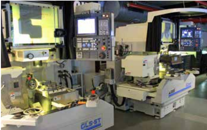
Machines de rectification par projection optique Amada, capables d'exécuter des déplacements extrêmement faibles avec des pas de seulement 0,1 µm.
