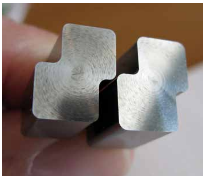
Gabarits de contrôle Go/NoGo usinés sur mesure par rectification par projection optique.
