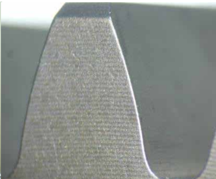
Faces des dents après l'usinage. Zahnflanken bearbeitet. Tooth flanks after finishing.
