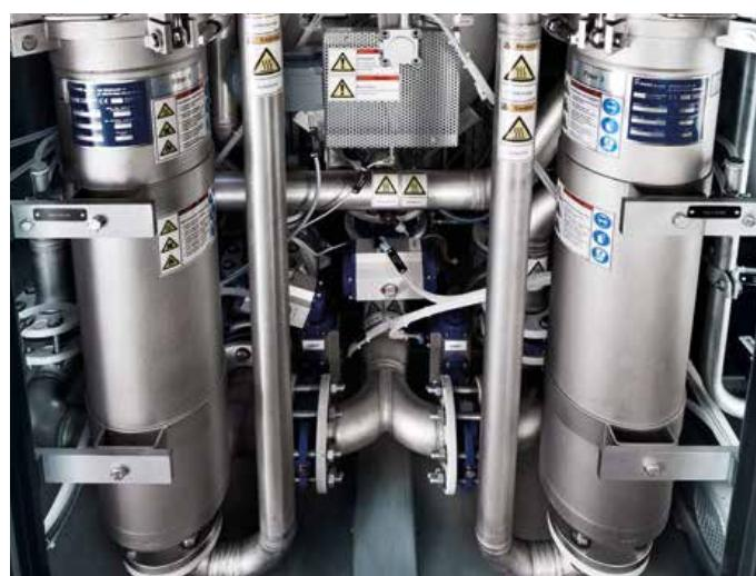
Corps de filtre combinés pour l'utilisation de filtres à poche et à bougie, filtration bypass, possibilité de double filtration, changement facile et rapide des filtres
