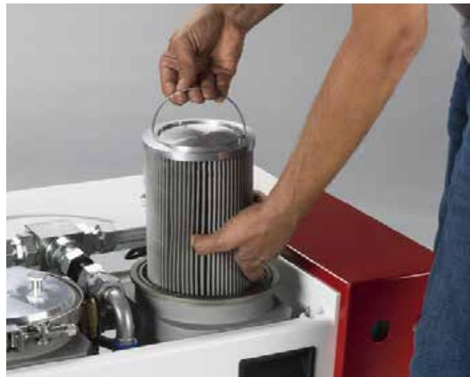
Avec la combiloop CL1 E aussi, le changement de filtre est simple et rapide grâce à l'accès pratique par le haut via un couvercle facilement détachable.
