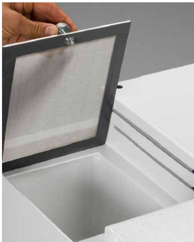
Nette augmentation de la durée de vie des filtres fins grâce au système de cuve à 3 chambres : la première chambre sert à la préfiltration. Le fluide se stabilise dans la deuxième chambre et s'écoule par le trop-plein dans la troisième chambre.
