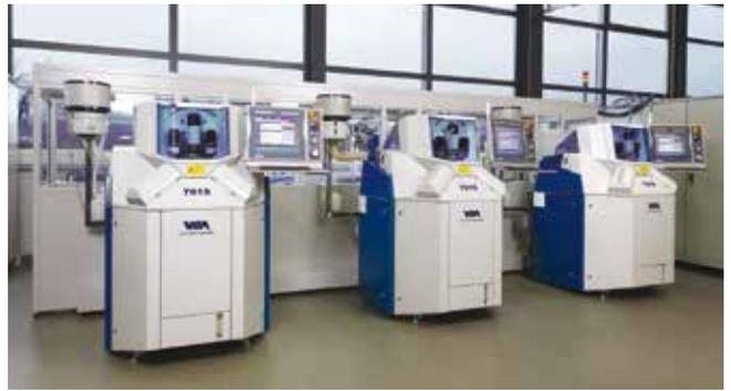
Autre exemple de cellule robotisée destinée au secteur horloger composée de 3 centres d'usinage 701S et d'un robot poly-articulé monté sur un axe linéaire.
