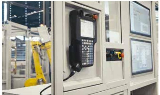
Tableau de commande de la cellule robotisée.
