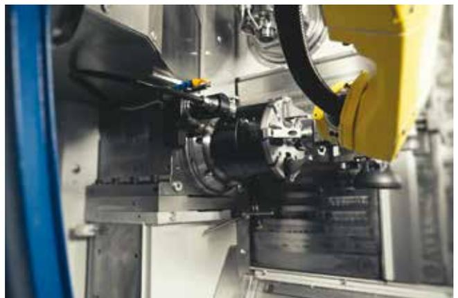
Chargement automatique d'une pièce sur la machine 508MT avec le robot poly-articulé.
