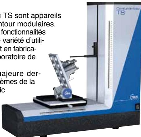
L'axe X porte la pièce à contrôler et la scrutation du profil se fait sur l'axe Z. Une électronique ultra-performante pilote la conduite des mesures et l'acquisition des données de mesure. Le granite est l'élément de choix pour assurer une parfaite stabilité.
