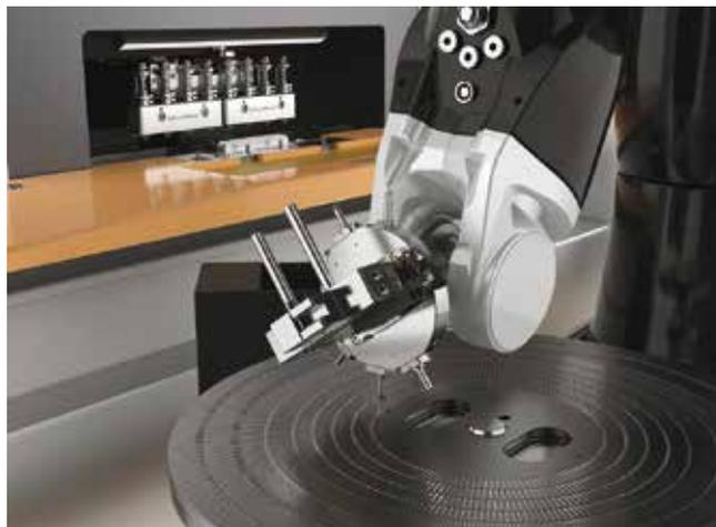
Le robot vient prendre les aiguilles préalablement disposées sur des disques pour les déposer avec une précision de 0,01mm dans la machine de pose des aiguilles.
