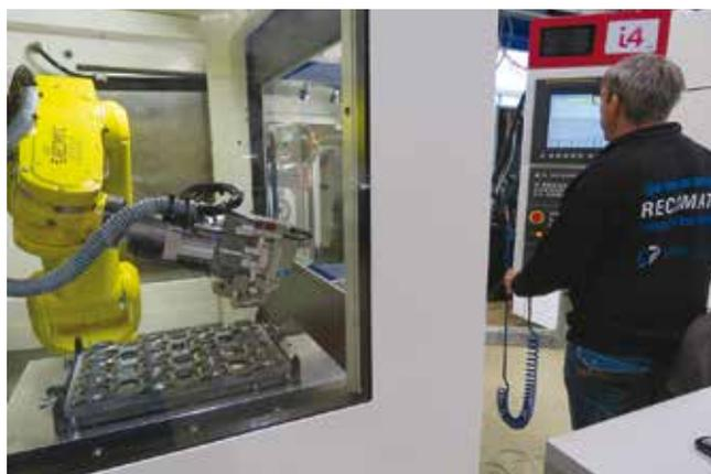
La robotisation des machines du Groupe Recomatic leur assure une grande autonomie et une qualité d'exécution irréprochable. Entre le robot Fanuc LR mate et la commande CNC Fanuc, la connexion est parfaite. Avant livraison, chaque machine est testée dans toutes ses fonctions.
