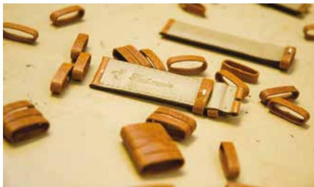
Dans les étapes de finition, on retrouve notamment le ponçage de la tranche et des trous (pour certains bracelets sport) réalisé à la main ou à la machine. Tranche et trous sont ensuite enduits de peinture, lissés, teints voire cirés. Le filetage permet quant à lui d'assouplir le cuir et de lui donner un bel aspect, par exemple par le trait rehaussant la bande entre le bord du bracelet et la couture.
