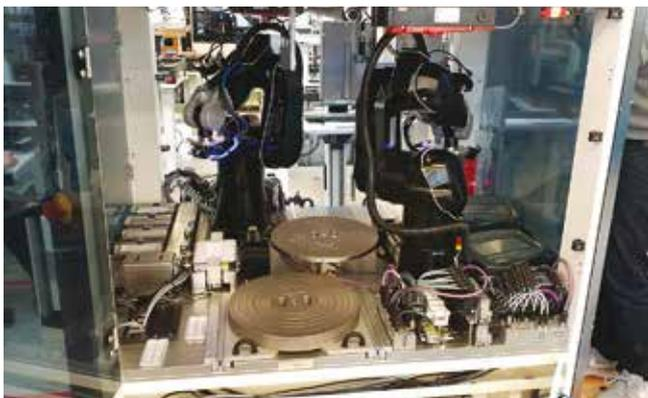
La cellule de tri des aiguilles, indépendante de la ligne automatisée, trie et conditionne 2'750 aiguilles par heure.
