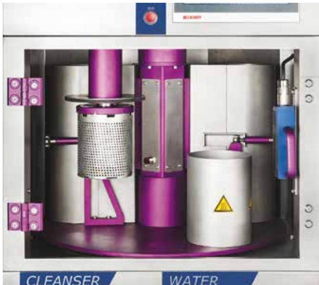
cas, les deux bacs contenant l'eau et le produit de nettoyage peuvent être supprimés au profit d'une alimentation directe et d'une évacuation par les égouts. Cette machine sera présentée à l'EPHJ sur le stand B-46 de Patric concept.
