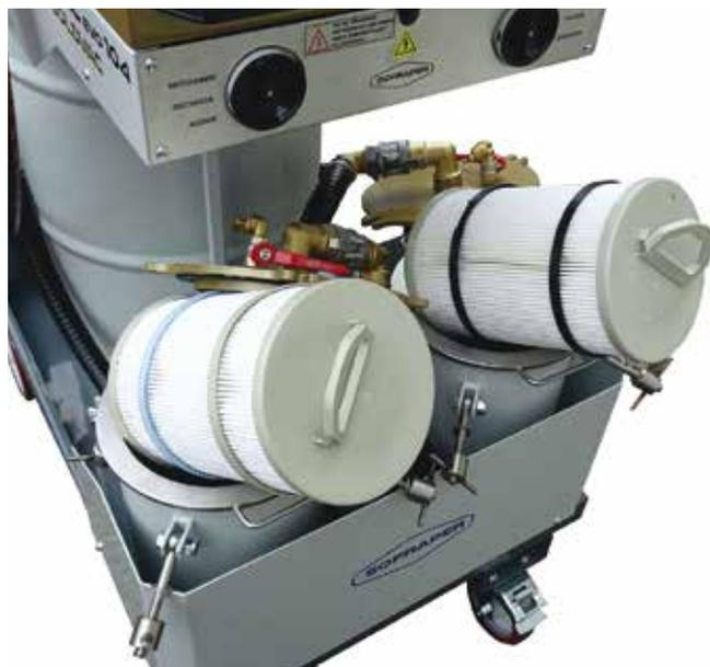
Les opérations de nettoyage et de récupération des métaux sont optimisées grâce notamment à l'aspiration directe dans la vidange gravitaire de la cuve par la pompe de refoulement. La vidange des pots de filtration au travers des deux cartouches par air comprimé contribue également à simplifier les travaux de nettoyage, de même que la surface lisse des conteneurs (amovibles) de cartouche en Inox.
