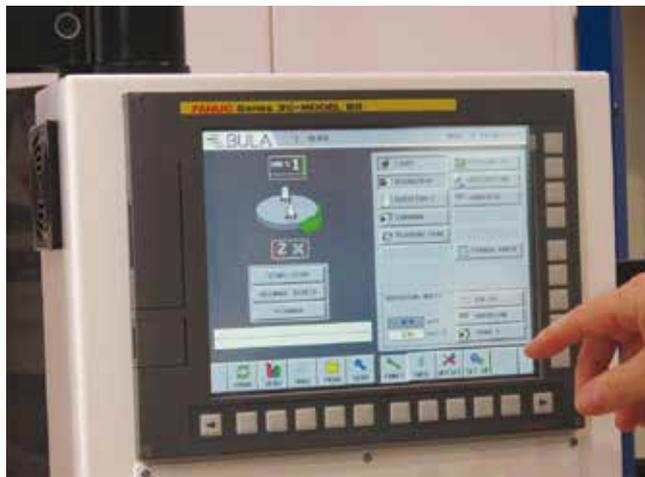
L'interface HMI développée par le Groupe Recomatic à partir de l'ouverture permise par Fanuc Pictures permet une programmation très conviviale des opérations de finition de surface, y compris par apprentissage. L'ouverture de la commande autorise l'installation facile d'un système robotique, quelle qu'en soit l'origine.
