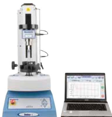
Le Couplemètre Helixa de Mecmesin est une solution idéale pour mesurer les variations de mesure entre de petits et moyens couples sur une multitude de produits fragiles ou de haute précision. Son alignement extrêmement précis le rend adéquat pour tester des assemblages de haute qualité présents dans les industries de la cosmétique, de la bijouterie, de l'électronique, de la pharmaceutique et médicale.
