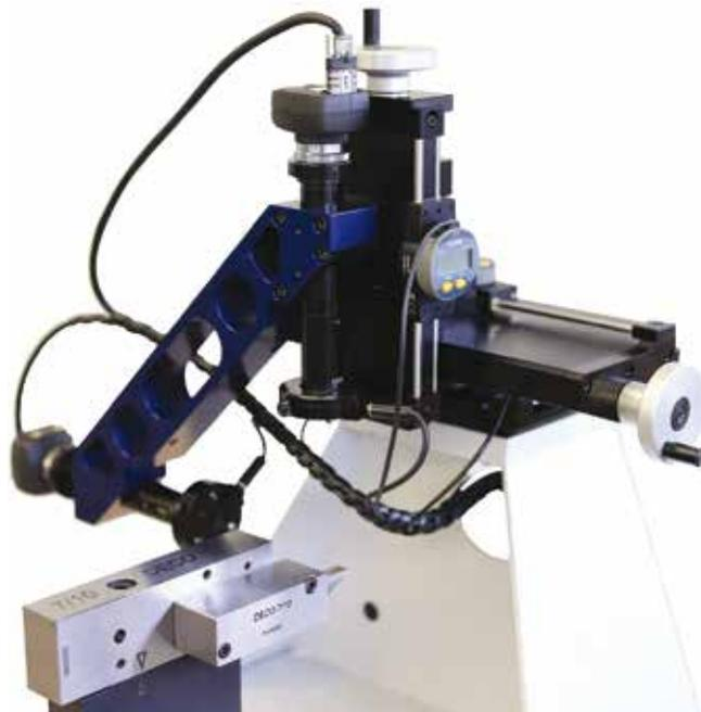
Pré-régleur Y-150 équipé de 2 caméras permettant un contrôle de l'outil sans contact.
