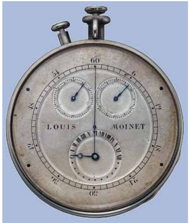
Chronographe au soixantième de seconde de Louis Moinet. Instrument à très haute fréquence: 216 000 alternances/heure, 30 Hz. échappement en rubis de Moinet. Le retour à zéro des compteurs s'effectue à l'aide d'un stylet correcteur indépendant. Au dos du chronographe, indicateur de réserve de marche, environ 30 heures. Platine supérieure signée Louis Moinet. D. 57,7 mm; ép. 9 mm.
