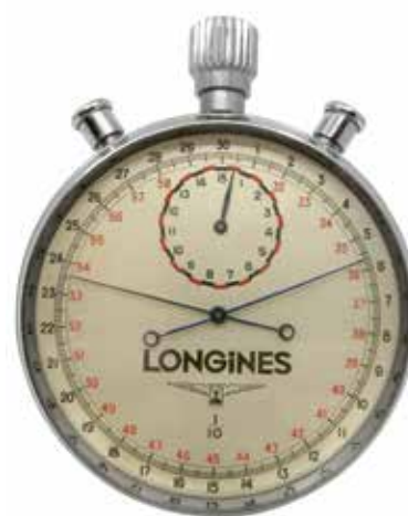
Compteur à haute fréquence au 1/10ème de seconde pour compétitions de ski (1939). Calibre 24 lignes basé sur chronomètre de marine, avec rattrapante, mouvement à haute fréquence battant à 36'000 alternances/heure.
